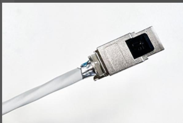
Při ukládání keystonu do patch panelu i zásuvky dbejte na **dodržení min. poloměru ohybu** určeného pro datové kabely (tj. 4 x průměr kabelu, viz ČSN EN 50174-2, část 4.4.1.2). Kabelové trasy i jejich jednotlivé části musí být na toto dopředu **připraveny** a dostatečně **dimenzovány**. Toto je obzvláště důležité u silnějších a hůře ohebných kabelů (např. CAT6A a vyšších).
