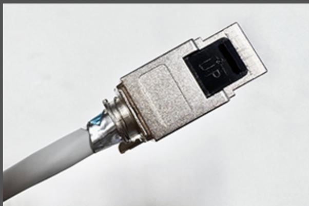
Zemnicí drátek (nebo oplet u S/FTP kabelů) **omotejte** kolem vodivé **zadní části** keystonu. Zemnicí drátek (popř. oplet) by se měl **dotýkat** těla keystonu co nejvíce a po celém obvodu zadního krčku. Z tohoto důvodu musí být zemnicí drátek (nebo oplet u S/FTP kabelů) **dostatečně dlouhý**.
