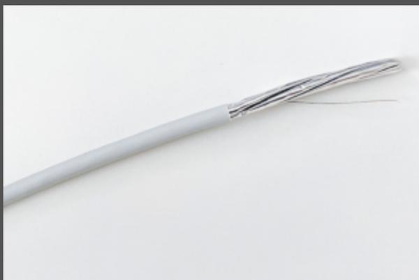
Odstraňte plášť kabelu minimálně v délce **50 mm**. V případě stíněných kabelů o něco více - tj. zemnicí drátek musí být **dostatečně dlouhý** (viz dále). Při instalaci kabelů si proto nechejte na obou koncích kabelu **větší rezervy**.
