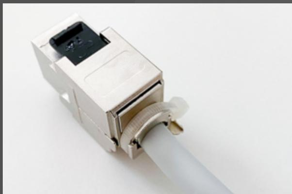
Pokud jste úspěšně **dokončili** všechny výše uvedené kroky, je instalace samořezných keystoneů Solarix **dokončena**. Při ukládání keystoneu do patch panelu i zásuvky dbejte na **dodržení min. poloměru ohybu** určeného pro datové kabely (tj. 4 x průměr kabelu, viz CSN EN 50174-2, část 4.4.1.2). Kabelové trasy i jejich jednotlivé části musí být na toto dopředu **připraveny** a dostatečně **dimenzovány**. Toto je obzvlášť důležité u silnějších a hůře ohebných kabelů (např. CAT6A a vyšších).
