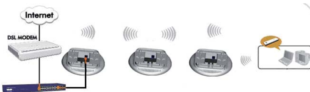
Obr. 1.8 – Topologie zapojení v režimu Wireless Repeater
