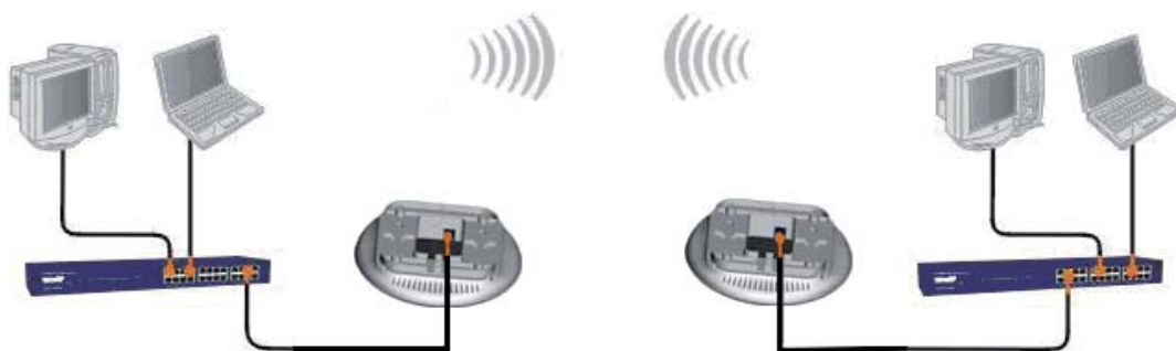
Obr. 1.6 – Topologie zapojení v režimu PTP Bridge
