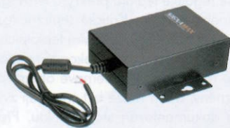
Zdroje napájení jsou také odolné a uchycují se často do switchů a routerů podobně jako v rozvedech elektrické sítě.
