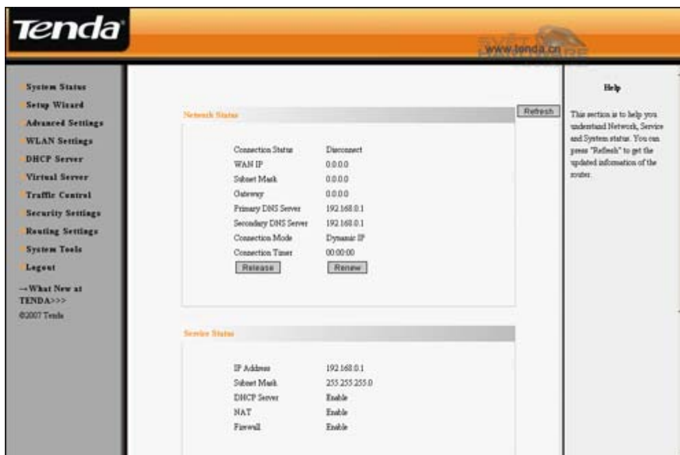
Uvodní obrazovka se statistikami drátové i bezdrátové sekce routeru. - pro zvětšení klikněte -
