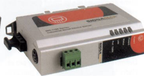
Průmyslový media konvertor s konektory pro optickou síť
