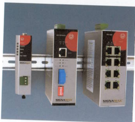
Průmyslové síťové prvky se umísťují nejčastěji na tzv. DIN lištu.
